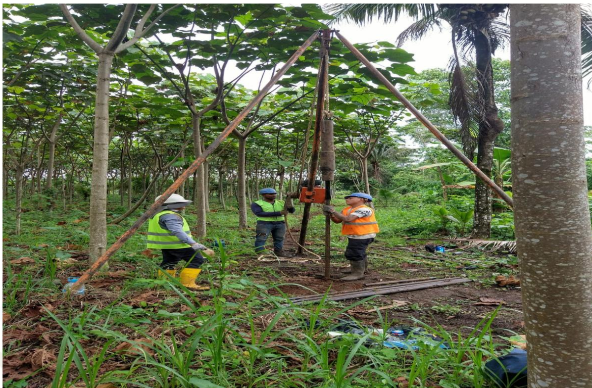
Perforación de pozo para toma de muestra.
